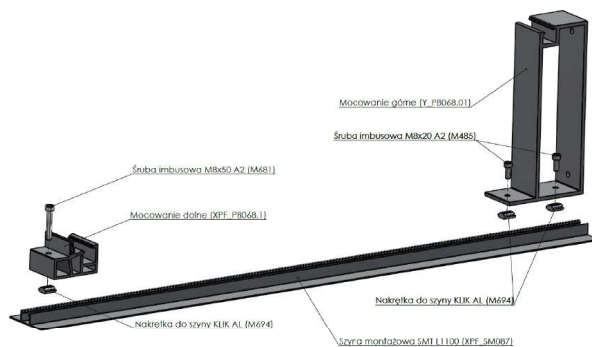
Rys. 1 Montaż mocowania dolnego (XPF_PB068.1) i górnego (Y_PB068.1) na szynie SMT L1100 (XPF_SM087)
